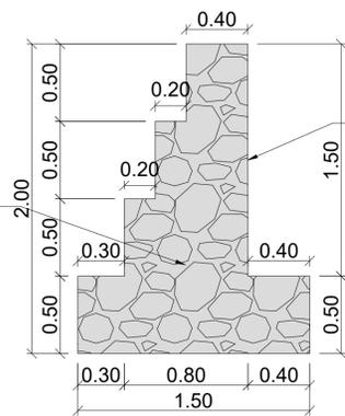
FACE DO MURO DE ARRIMO EM PEDRA ARGAMASSADA COM ACABAMENTO (PEDRAS REJUNTADAS E FRISADAS).
