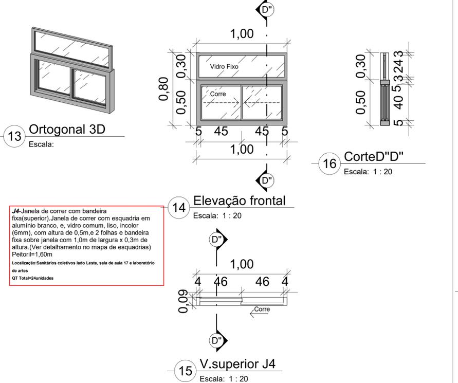
**J4-Janela de correr com bandeira fixa(superior).** Janela de correr com esquadria em alumínio branco, e, vidro comum, liso, incolor (6mm), com altura de 0,5m, e 2 folhas e bandeira fixa sobre janela com 1,0m de largura x 0,3m de altura. (Ver detalhamento no mapa de esquadrias)
