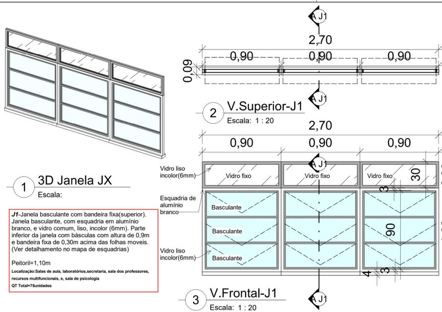
**J1-Janela basculante com bandeira fixa(superior).** Janela basculante, com esquadria em alumínio branco, e vidro comum, liso, incolor (6mm). Parte inferior da janela com bsculas com altura de 0,9m e bandeira fixa de 0,30m acima das folhas moveis. (Ver detalhamento no mapa de esquadrias)
