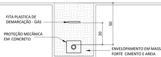
**DETALHE 07: TUBULAÇÃO ENTERRADA - ÁREA DE PASSAGEM DE VEÍCULOS**
